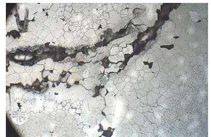
Vista da superfície de um aço inoxidável austenítico com corrosão intergranular
