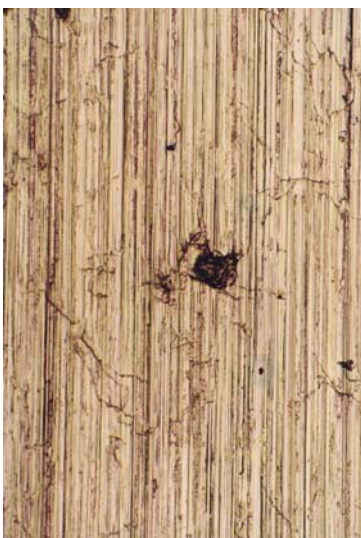
Partícula de ferro incrustada vista com microscópio ótico.
