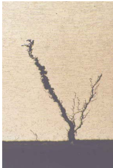
Trinca ramificada típica de CST
